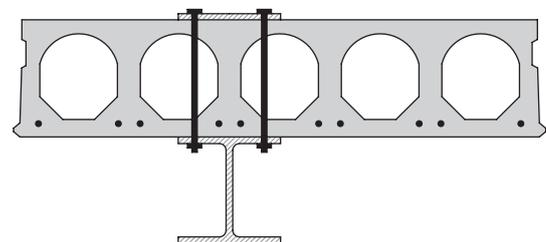
Diese Befestigung erlauben höhere Ausziehlasten als die Befestigung mit Hohlraumdübel.
