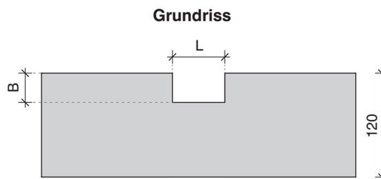
Anmerkung: Diese Aussparung ist nur möglich, wenn der ausgesparte Plattenrand kein „freier Deckenrand“ ist.
