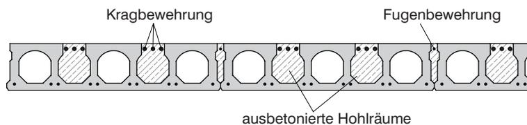
Am Plattenende müssen die Spannlitzen bauseits gegen Korrosion geschützt werden.
