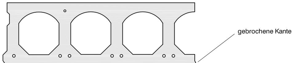
Passplatten werden in der Regel am Rand eines Deckenfeldes angeordnet. Sind Passplatten im Verlegefeld notwendig, erhält die Platte auf der Oberseite einen zweiten Längsschnitt. Damit ist die fachgerechte Herstellung des Fugenvergusses sichergestellt.
